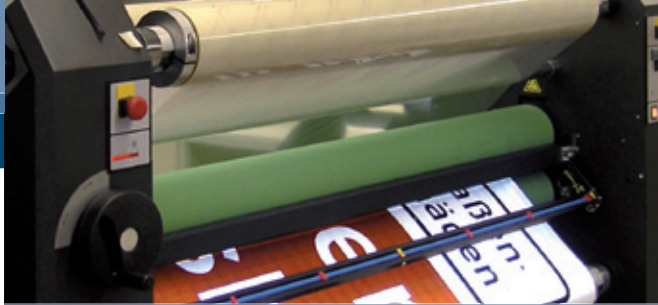
Applizieren des Schutzlaminates
