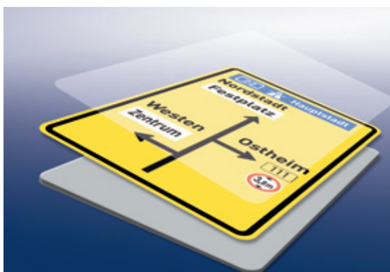
Aufbau von Verkehrszeichen im Digitaldruck
